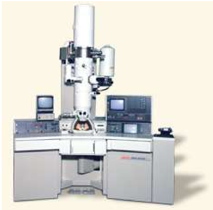
Εικόνα 7. α) Βασικά οπτικά στοιχεία ηλεκτρονικού μικροσκοπίου διερχόμενης δέσμης. Το δείγμα τοποθετείται στη θέση Α και μέσω διαδοχικών ενδιάμεσων ειδώλων σχηματίζεται η τελική εικόνα στη θέση Ε, β) εικόνα σύγχρονου TEM (JEOL 2010F)
